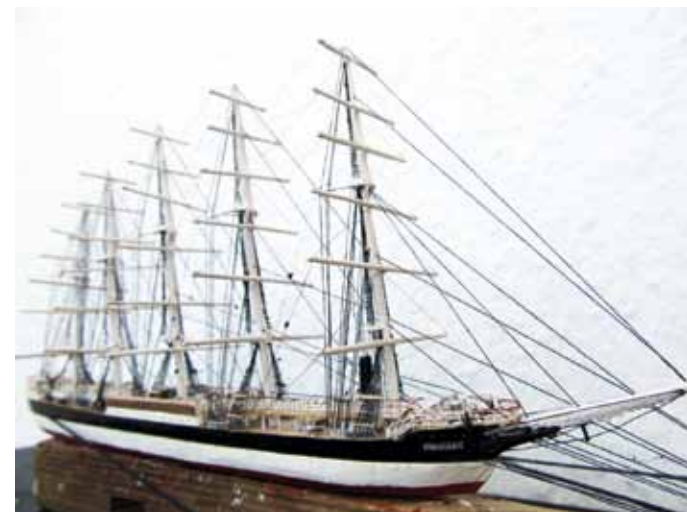
Als Rahen und Besangaffeln beweglich an den Masten angebracht waren, kam das laufende Gut wie Brassen und Toppnanten aus echtem Menschenhaar hinzu
