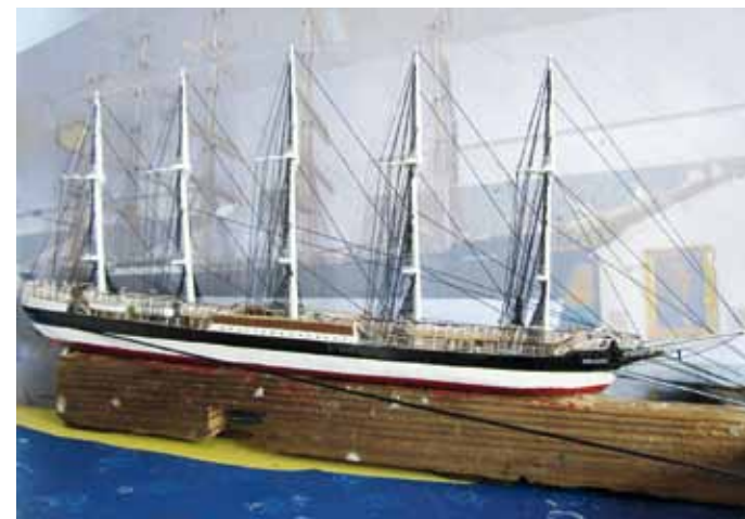
Wanten und Pardunen sind aufgetakelt. Im Hintergrund ist als Ausdruck das große Modell der PREUSSEN aus dem Historischen Museum Bremerhaven zu sehen
