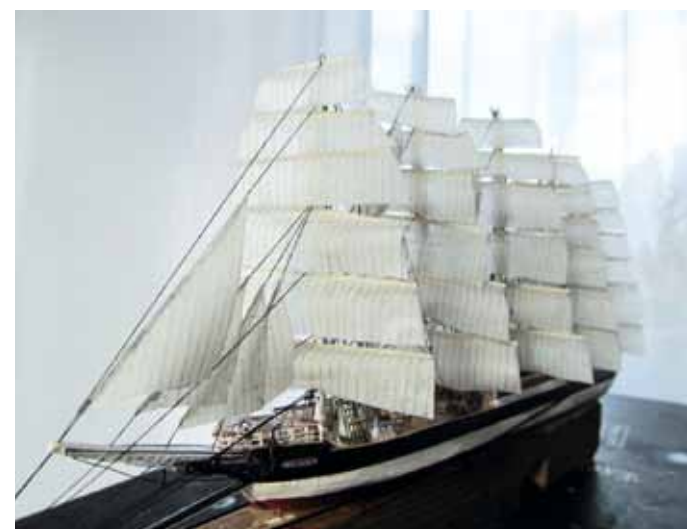
Für die Segel kam Japanpapier zum Einsatz. Sie wurden zuvor in eine Mischung aus viel Wasser und ein wenig Weißleim getaucht
